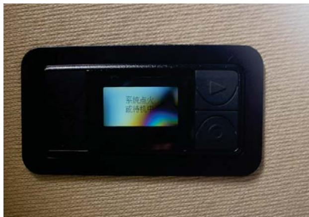
کلید روشن شدن [ ] را به مدت چند ثانیه نگه دارید تا بخاری درجا شروع به کار نماید. زمان مورد نیاز برای دمیدن باد گرم بین ۸ تا ۲۰ دقیقه می‌باشد. برای خاموش کردن بخاری درجا نیز باید کلید خاموش کردن [ ] را به مدت چند ثانیه فشار دهید.
